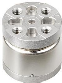
本製品は、フォース 3 軸、モーメント 3 軸の 6 軸力覚センサです。MEMS チップと金属構造体のハイブリッド構造により 6 軸検出を行います。モジュール内に AFE IC を内蔵しており、デジタル出力(SPI)されます。マトリクス演算(他軸干渉成分除去)で使用する補正係数は AFE IC 内部メモリに格納されており、測定開始直前に読み出すことが可能な為、ユーザー側でセンサと補正係数の管理が不要です。また、モジュール内には LDO を内蔵している為、低ノイズ化を実現しています。非常に小型で軽量の形状でロボットハンド指先への搭載に最適です。
